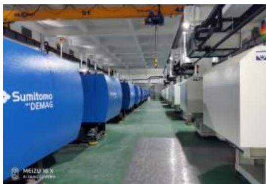
住友全电动注塑机稳定性好，提高产品成品率。同样吨位的全电动注塑机比油压机省电60%以上。目前我们已经有100多台全电动注塑机，为公司节省了电能60%以上。
